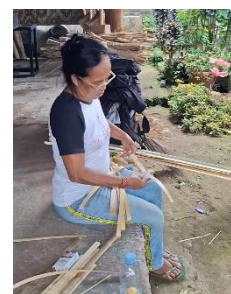
Gambar 3. Proses Irat bambu manual Berdasarkan Tabel 4, proses irat manual membutuhkan waktu lebih lama yaitu 73 detik dibandingkan dengan alat otomatis yang hanya 50 detik. Selain itu,
