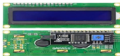
Gambar 9. LCD 16x2 digabung dengan I2C
