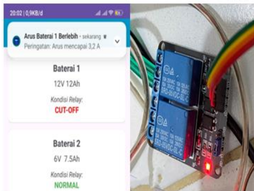
Gambar 8. Pengujian Arus Berlebih
