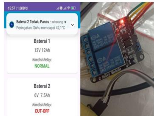
Gambar 6. Pengujian Suhu Berlebih
