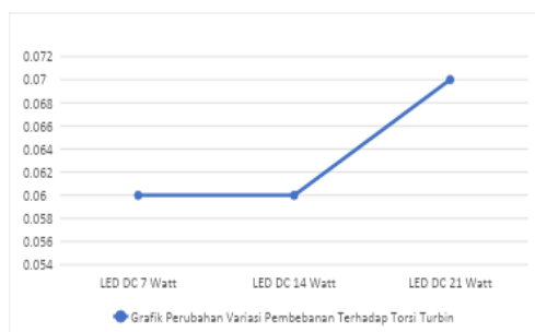
Gambar 13. Grafik Perubahan Variasi Pembebanan Terhadap Torsi Turbin
