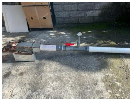
Gambar 7. Realisasi Sistem PLTMH dengan Turbin Cross-Flow Secara Keseluruhan
