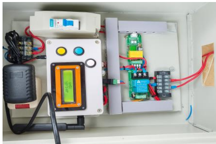
Gambar 8. Perancangan Keseluruhan Penggunaan Sensor PZEM004T Pada Bangunan Cerdas [28]
