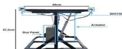
Gambar 2. Realisasi solar tracker
