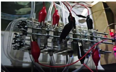
Gambar 11. Realisasi baterai aluminium- karbon empat sel (5 x 5 x 0,2 cm)
