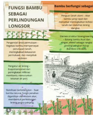
Gambar 13. Fungsi bambu yang dapat memperkuat tanah dari longsor
