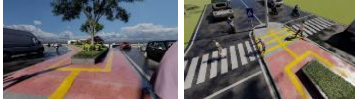
Gambar 8. a. Visualisasi desain pelebaran trotoar sesuai standar, dilengkapi guding block , ramp .
