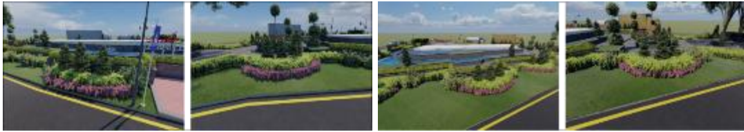
Gambar 4. Visualisasi desain penutupan 4 akses masuk, dibatasi dengan planter dan vegetasi pembatas. Fasilitas trotoar direkomendasikan untuk diperluas menjadi minimal 1,85 m, dilengkapi guiding block dan ramp . Tambahan jalur trotoar pendek juga disarankan agar zebra cross di sisi utara dan selatan dapat terhubung langsung ke taman.
