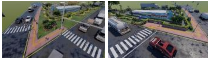
Gambar 5. Visualisasi desain penambahan trotoar pendek di sisi utara dan selatan TITRS untuk terhubung ke fasilitas penyeberangan zebra cross
