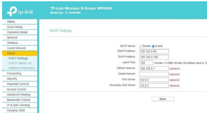
Gambar 3.6. Pengaturan DHCP IP pada Router TP Link
