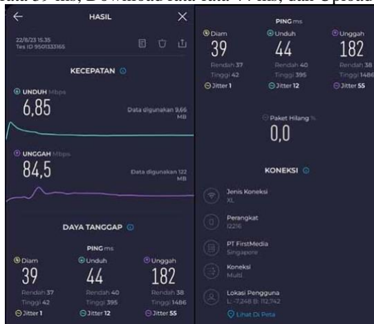
Gambar 3.14. Hasil Speedtest Bandwidth Wireless Router TP Link dengan server Singapore secara wireless
