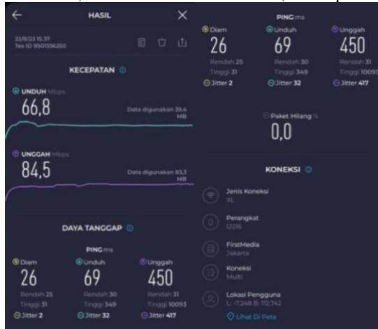
Gambar 3.13. Hasil Speedtest Bandwidth Wireless Router TP Link dengan server Jakarta secara wireless
