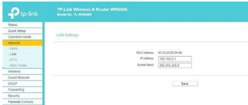
Gambar 3.3. Pengaturan LAN pada Wireless Router TP Link
