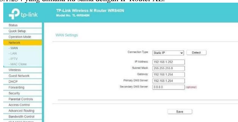
Gambar 3.2. Pengaturan WAN pada Wireless Router TP Link
