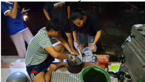
Gambar 7. Proses pengadonan briket limbah upacara (canang)
