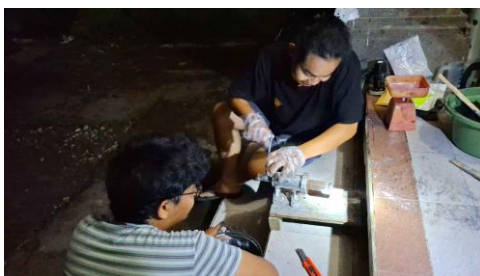
Gambar 8. Proses pencetakan briket limbah upacara (canang)
