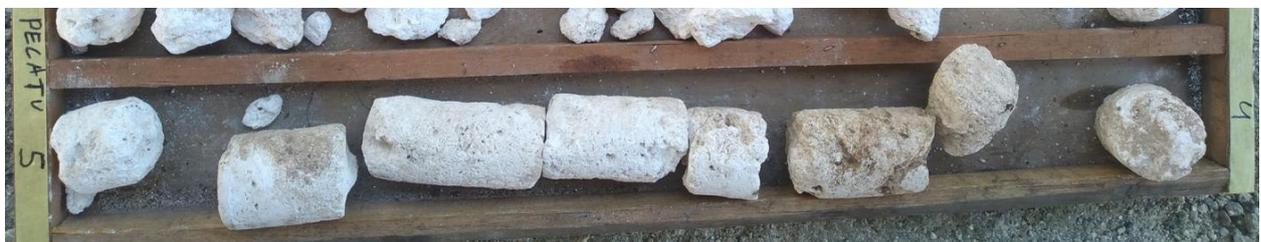
Figure 6. Core box hasil pengeboran di daerah Pantai Bingin kedalaman 4-5 meter.
